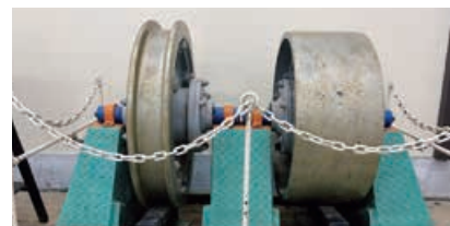
④溝車輪（左側）⑤平車輪（右側）
