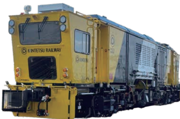
新型レール削正車“きずな” (ROMILL 600)
