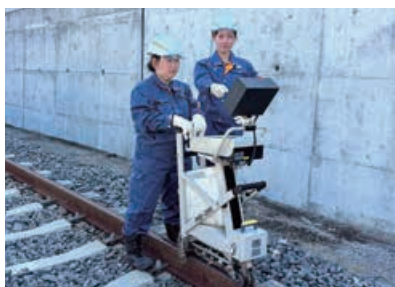
レールの傷を探す作業（レール探傷器）
