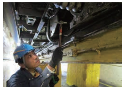
床下機器の検査
