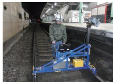
軌道測定作業（レーザー式ホーム限界測定装置）
